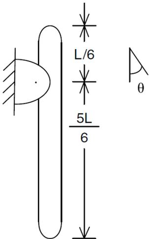
**Suposiciones:** La barra tiene una distribución de masa uniforme y se puede modelar como un cuerpo rígido, el sistema solo tiene un grado de libertad y la coordenada generalizada a emplear es el desplazamiento angular  $\theta$ , sobre el sistema no actúa ninguna fuerza no conservativa.
