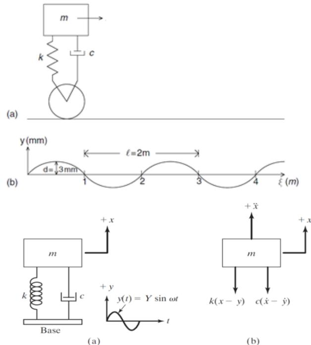
**Suposiciones:** Suspensión de auto que puede ser modelado como un sistema de un grado de libertad de masa-resorte-amortiguador, donde la masa es puntual, hay amortiguamiento viscoso, y el resorte se comporta de forma lineal; el camino recorrido por el sistema de suspensión presenta el contorno sinusoidal que se observa en la figura; la coordenada generalizada a emplear para describir el desplazamiento vertical del sistema de suspensión será  $x$ .
