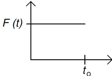
**Suposiciones:** Sistema masa-resorte de un grado de libertad sujeto a la siguiente ecuación diferencial  $m\ddot{x} + kx = F(t)$ , el resorte se comporta de forma lineal.
