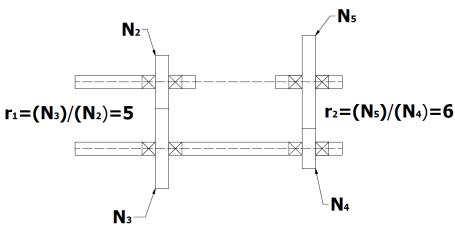
1. Diseñe un tren compuesto (al menos un eje carga más de un engrane) revertido (eje de salida es concéntrico con el de entrada) con engranes rectos para una razón de 30:1 (valor de tren igual a 1/30) y un paso diametral de 10 dientes por pulgada. Especifique el número de dientes de cada engrane y los diámetros de paso. Haga el esquemático del tren de engranes. Considere una razón por etapa máxima de 10:1 y un número de dientes mínimo de 12.
