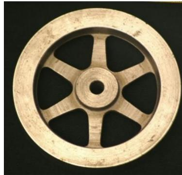
**Suposiciones:** El peso y volumen de los rayos del volante es despreciable, el momento de inercia del volante de será el de un tubo cilíndrico con extremos abiertos y de longitud  $h$  ( $I = \frac{m}{2}(r_i^2 + r_o^2)$ ), la densidad del hierro fundido se tomará igual a  $7200 \text{ kg/m}^3$ .
