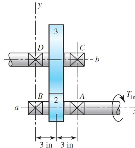
**Suposiciones:** Los cojinetes A y B están sujetos a las mismas cargas impuestas únicamente por el eje a, los cojinetes D y C están sujetos a las mismas cargas impuestas únicamente por el eje b.
