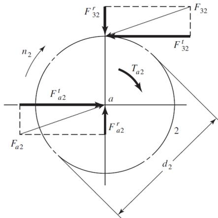
Aquí la única componente útil de  $F_{32}$  es la tangencial, la cual es definida como la carga transmitida  $W_t = F_{32}^t$ , y el torque relacionado con la carga transmitida puede ser expresado como:
