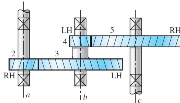
**Suposiciones:** Las únicas fuerzas actuando sobre el eje b son las del engrane 3 y 4. La velocidad angular del engrane 3 es igual a la del engrane 4.
