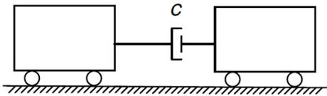
El carrito a la derecha del amortiguador puede ser descrito por medio de una coordenada generalizada  $x_2$  y a la izquierda del amortiguador por una coordenada generalizada  $x_1$ . Suponiendo  $x_2 > x_1$ , la fuerza desarrollada  $F$  estaría dada por:
