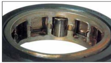
Componente: Jaula de rodamiento de rodillos cilíndricos. Sintoma: Deformación y deterioro de la jaula de latón maquinado.
