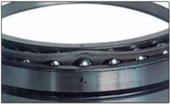
Componente: Jaula de rodamiento de contacto angular. Sintoma: Deformación de jaula de acero prensado. Causa: Choques durante el manejo.
