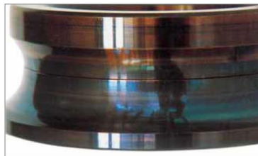
Componente: Anillo externo de rodamiento de contacto angular. Sintoma: Alteración de color de la superficie de la pista. Causa: Generación de calor debido a lubricación deficiente.
