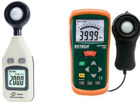
El nivel de iluminación se mide con un **luxómetro** que convierte la energía luminosa en una señal eléctrica, que posteriormente se amplifica y permite una fácil lectura en una escala de lux calibrada.
