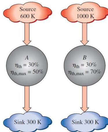
Aquí se puede ver como a pesar de que la máquina térmica B presenta una mayor eficiencia de Carnot, su eficiencia térmica al operar durante un proceso real es igual a la de la máquina térmica A.
