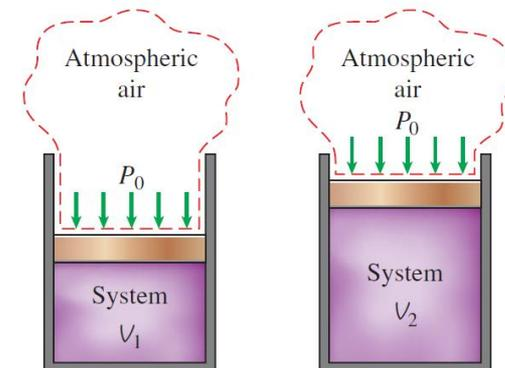
Aquí parte del trabajo de frontera es empleado para vencer la presión atmosférica y no puede ser empleado para otro propósito.
