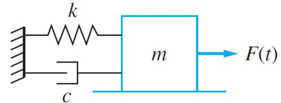
Paso 1. Se selecciona una coordenada generalizada. Se considerará que el desplazamiento  $x(t)$  en dirección de  $F(t)$  será la coordenada generalizada a emplear.
