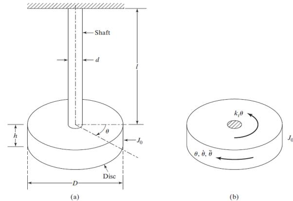
Aquí disco está sujeto a un eje flexible con las propiedades geométricas mostradas en la figura. Dicho sistema es analizado como si solo tuviera un grado de libertad bajo vibración torsional no amortiguada.
